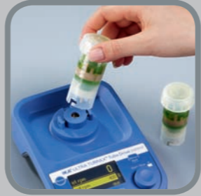
第七步 将分散试管从分散机上取下。
