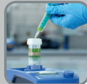
第九步 如果有需要，可用注射器通过试管盖上的薄膜插入试管进行样品提取。
