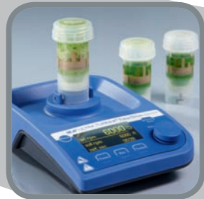
第五步 通过DT分散管的定-转子运转将薄荷叶均质。
