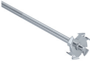
R 1303 DissolVERRührer Radiale Strömung, Ansaugen des Mischguts von oben und unten. Hohe Turbulenz, hohe Scherkräfte, Teilchenzerkleinerung. Einsatz bei mittleren bis hohen Drehzahlen. Ident-Nr.: 0002746700
