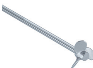
R 1381 Propellerrührer, 3-flügelig Strömungsgünstige Form. Ansaugen des Mischguts von oben und unten, geringe Scherkräfte. Einsatz bei mittleren bis hohen Drehzahlen. Ident-Nr.: 0001296000
