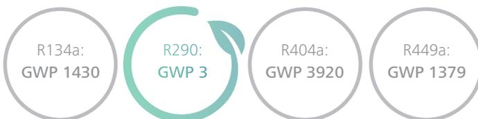
Dies bedeutet eine Verringerung des Treibhauspotenzials auf nur 0,21 % des Basiswertes von R134a. Dabei ist noch nicht berücksichtigt, dass auch die Kältemittelfüllmengen für R290 reduziert werden können.
