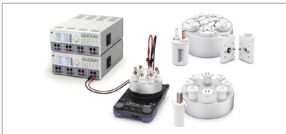
Abb. 2: Das kommerzielle Screening-System von IKA. Links: Aufbau bestehend aus zwei Mehrkanal-Gleichstromquellen, einer Heizplatte und dem Reaktionsblock inklusive 8 ungeteilten Zellen. Rechts oben: Reaktionsblock und einzelne geteilte Elektrolysezelle sowie zwei Halbzellen. Rechts unten: Reaktionsblock und einzelne ungeteilte Elektrolysezelle.
