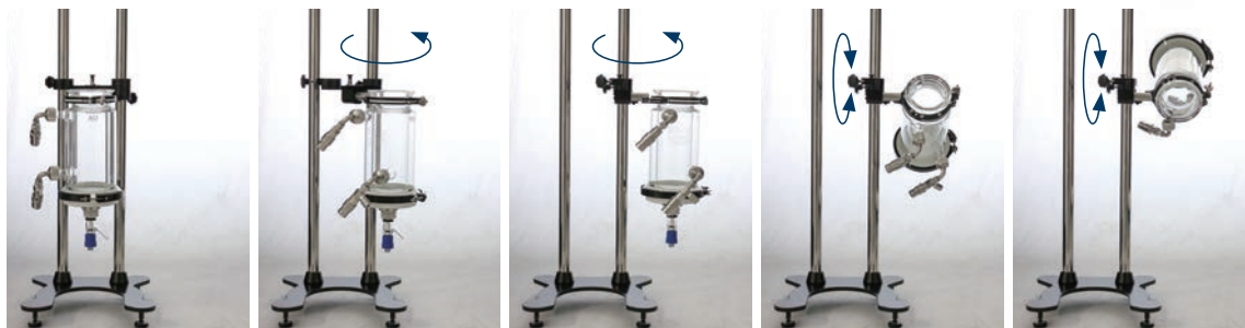
360°釜体可以 360°旋转，便于转移和清洗
