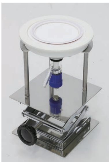
过滤器升降台
