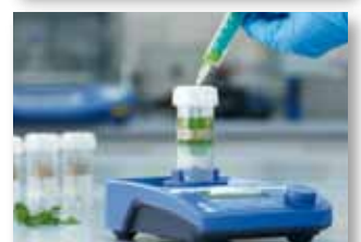
Beispiel: Homogenisieren von Minzblättern mit anschließender Probenentnahme
