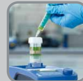
Schritt 9 Bei Bedarf kann die Probe durch eine durchstechbare Deckelmembran mit einer Spritze zur Analyse entnommen werden.
